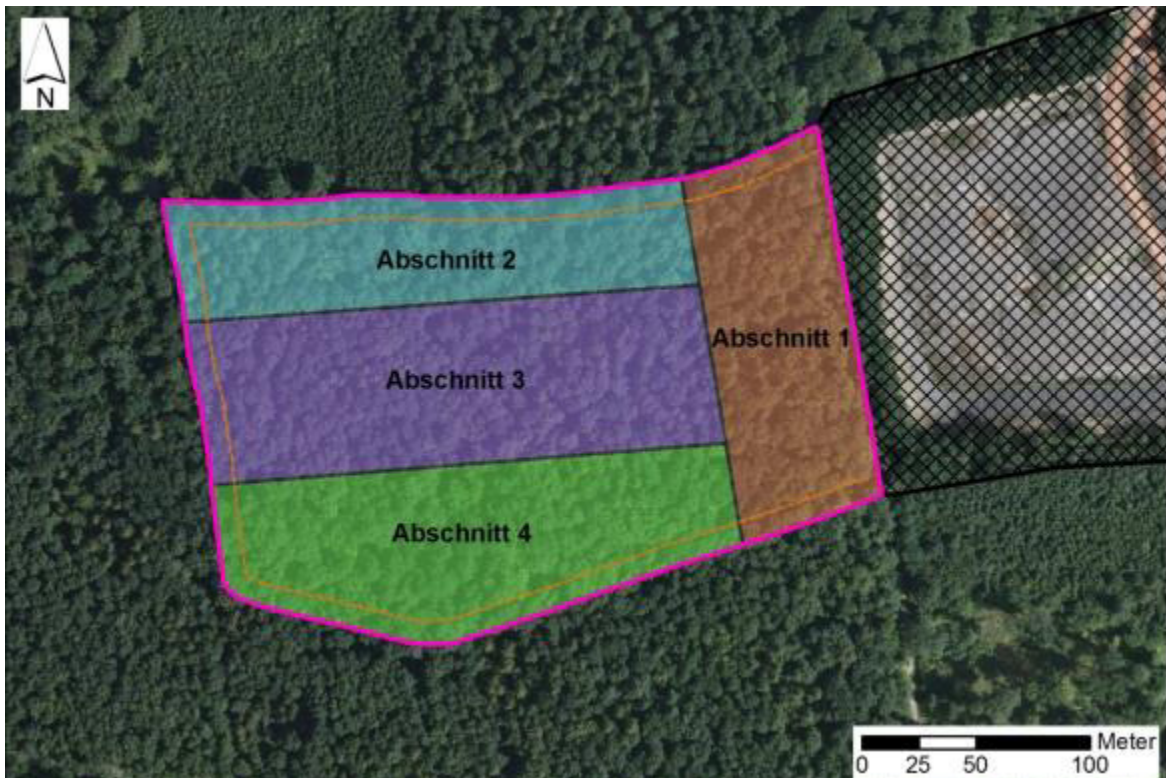
Abbildung 5: Abbaubabschnitte (1 bis 4) der Erweiterungsfläche (pinke Umrandung: Erweiterungsfläche, beige Umrandung: Abbaufäche ohne Sicherheitsstreifen, schwarze Kreuzschraffur: Resttonflächen in der bestehenden Tongrube)
